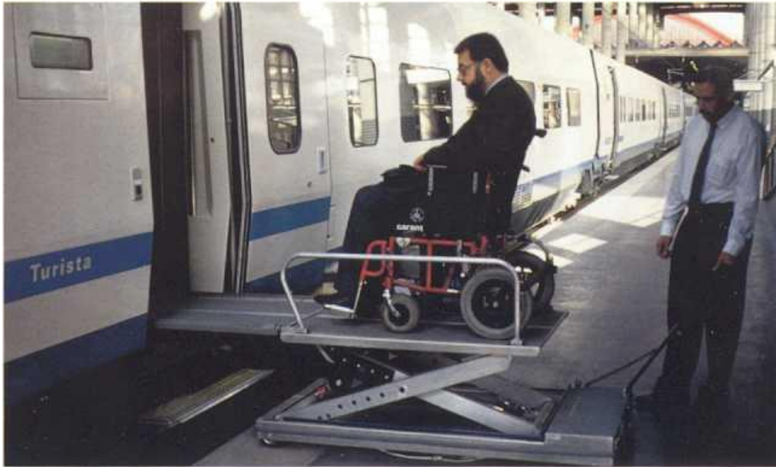
Francisco García Aznárez probando una plataforma elevadora de acceso al AVE Madrid-Sevilla, 1992. (Foto del archivo de FGA)
