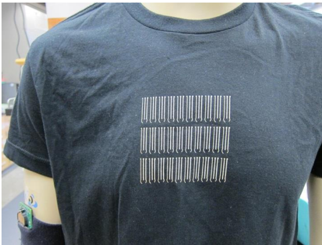
Imagen 3. Camiseta con electrodos que detectan la temperatura corporal
