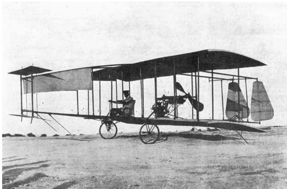
1.12. El nuevo siglo se abre, entre múltiples adelantos, con los comienzos de la aviación: Biplano con hélice propulsora construido en 1909 por Gaspar Brunet y Viadera (1867-1928), ingeniero industrial (Barcelona, 1889). A los mandos está, en Paterna, Juan Olivert Serra (1887-1949), también ingeniero industrial, que con la Diputación Provincial de Valencia cofinanció el desarrollo. A Brunet se debe el primer tratado español sobre técnica de aviación. «El libro constituye una sorpresa, pues no es de esperar, en esa fecha, una publicación tan extensa y completa de conocimientos técnicos y prácticos sobre aeroplanos» (J. M. a ROMÁN Y ARROYO, Tres escuelas y veinte promociones de ingenieros aeronáuticos, ETS, Asociación y CC. OO. de Ingenieros Aeronáuticos, Madrid, 1993 ).
