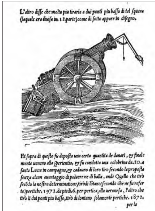
10.6. Cañón montado en su cureña, midiendo la elevación con un cuadrante. Hernán del Castillo , Libro muy curioso y utilísimo de artillería, h. 1560. Biblioteca Nacional, Madrid.
