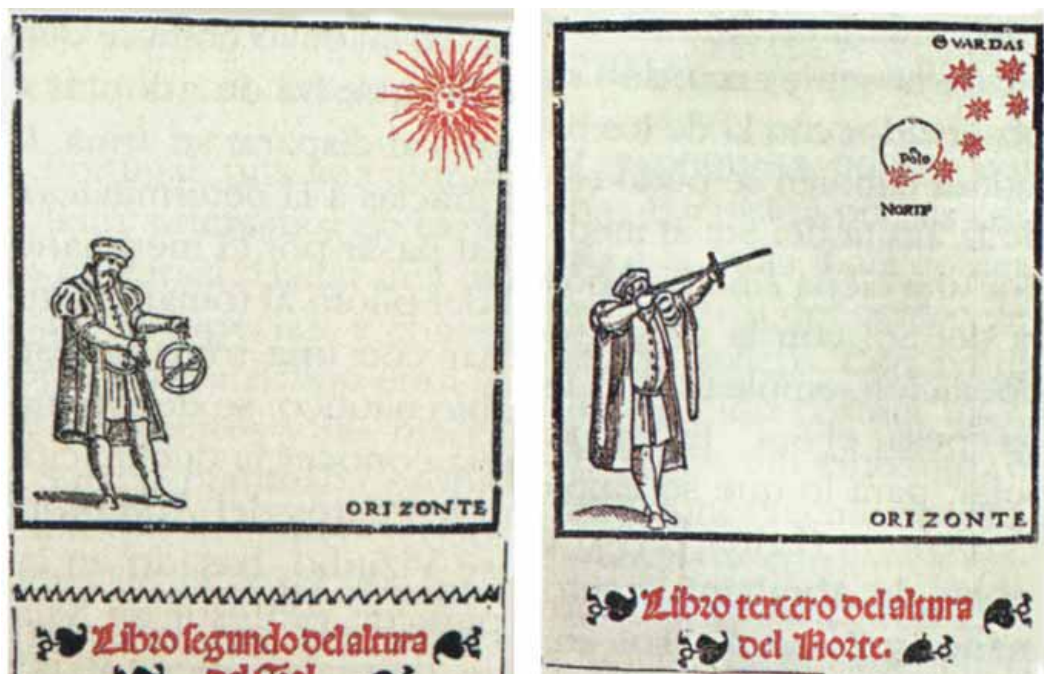
14.3. Navegantes: «pesando el sol» con el astrolabio (medición de su altura) y manejando la balles-tilla (observación de la estrella Polar y de la posición de las guardas). Ilustraciones que aparecen en obras de Pedro de Medina.
