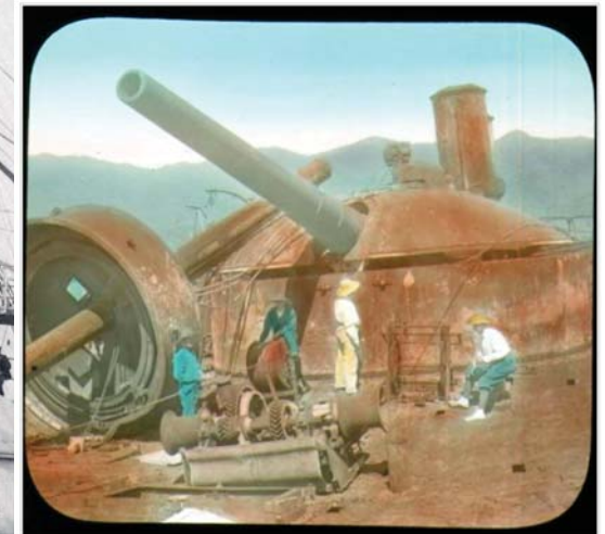
Una de las torres de artillería del Almirante Oquendo, con un cañón Hontoria de 280 mm.
