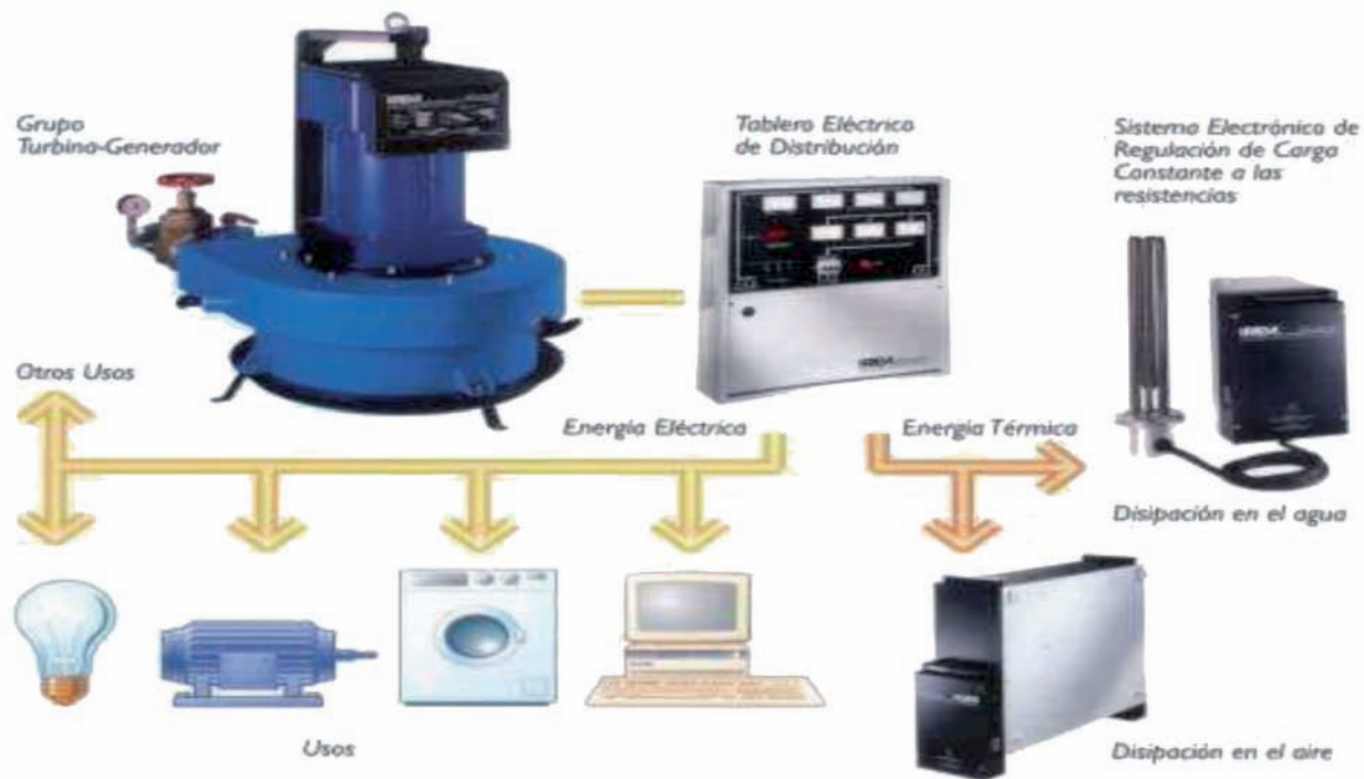
Figura 4.8. Componentes de una central microhidroeléctrica. Fuente: Saltos del Pirineo.
