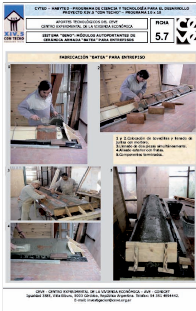
Figura 9.19. Ficha para la producción manual de un elemento 'batea' del CEVE tomada del libro 'Techos para Vivir' que se reseña en este Apartado.
