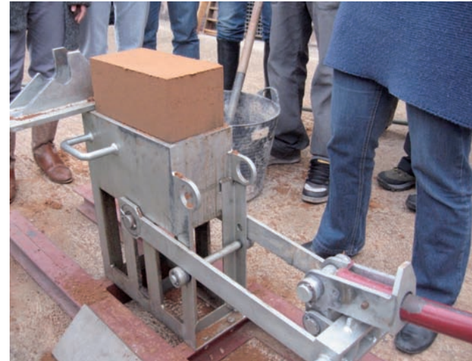
Figura 9.18. Máquina CINVARAM de fabricación prácticamente universal y peso inferior a 100 Kg. para la producción manual de adobes mediante compactación por palanca manual (J. Salas).
